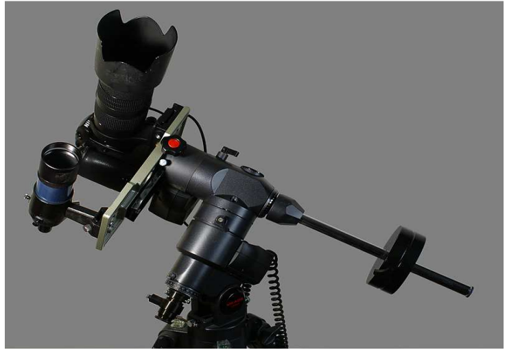
Un appareil photo reflex avec une télécommande, une monture équatoriale motorisée pour compenser la rotation de la Terre et une lunette guide : De très belles photos du ciel profond sont possibles : La Voie Lactée par François BRIONNE
